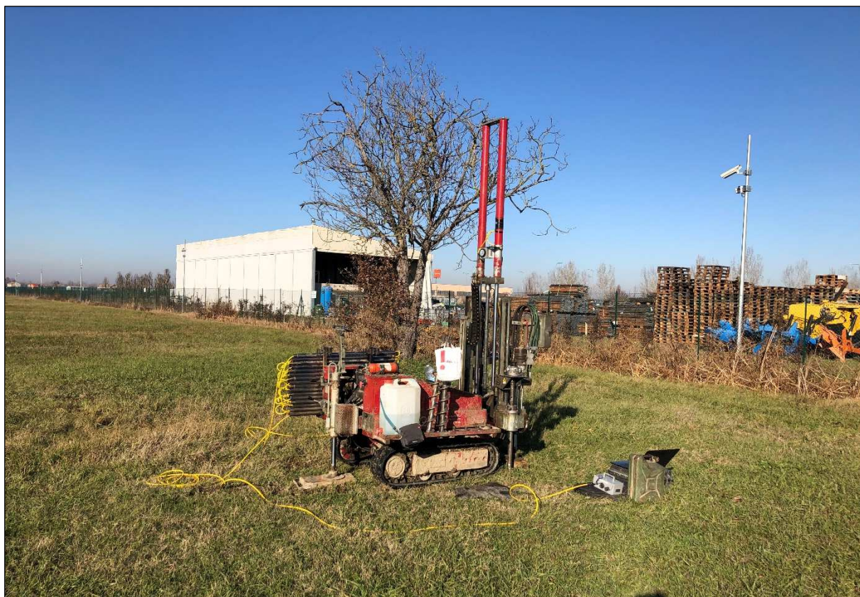
Fig. 4.1-5 Fasi esecutive della prova CPTU5
