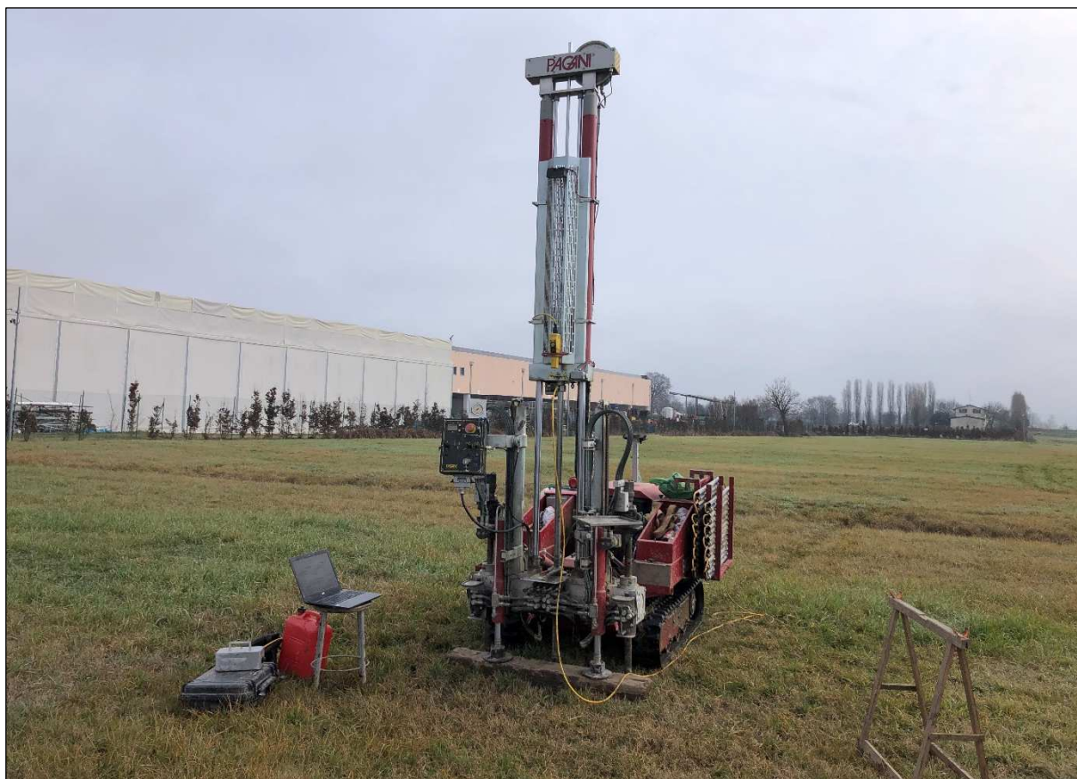
Fig. 4.1-11 Fasi esecutive della prova CPTU11
