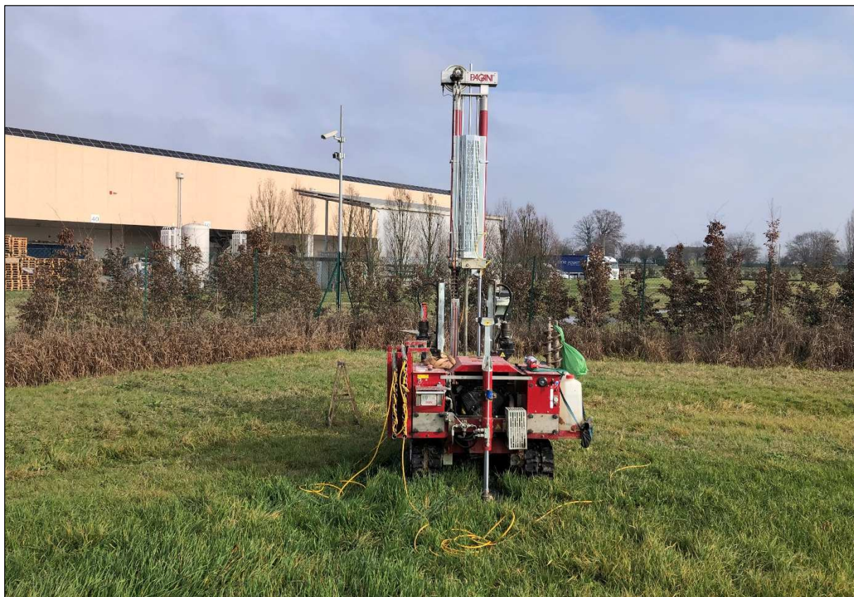
Fig. 4.1-10 Fasi esecutive della prova CPTU10
