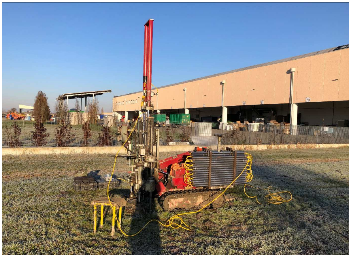
Fig. 4.1-2 Fasi esecutive della prova CPTU2
