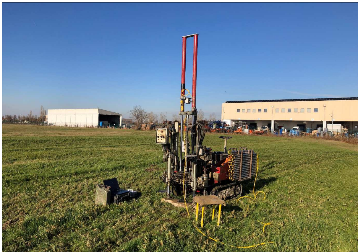
Fig. 4.1-6 Fasi esecutive della prova CPTU6
