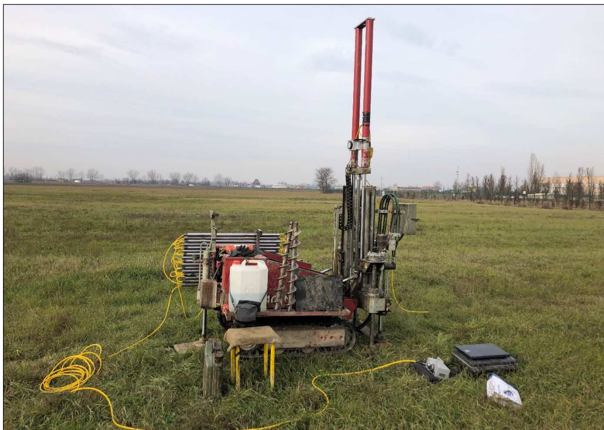
Fig. 4.1-7 Fasi esecutive della prova CPTU7
