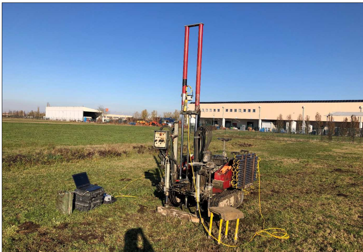
Fig. 4.1-1 Fasi esecutive della prova CPTU1
