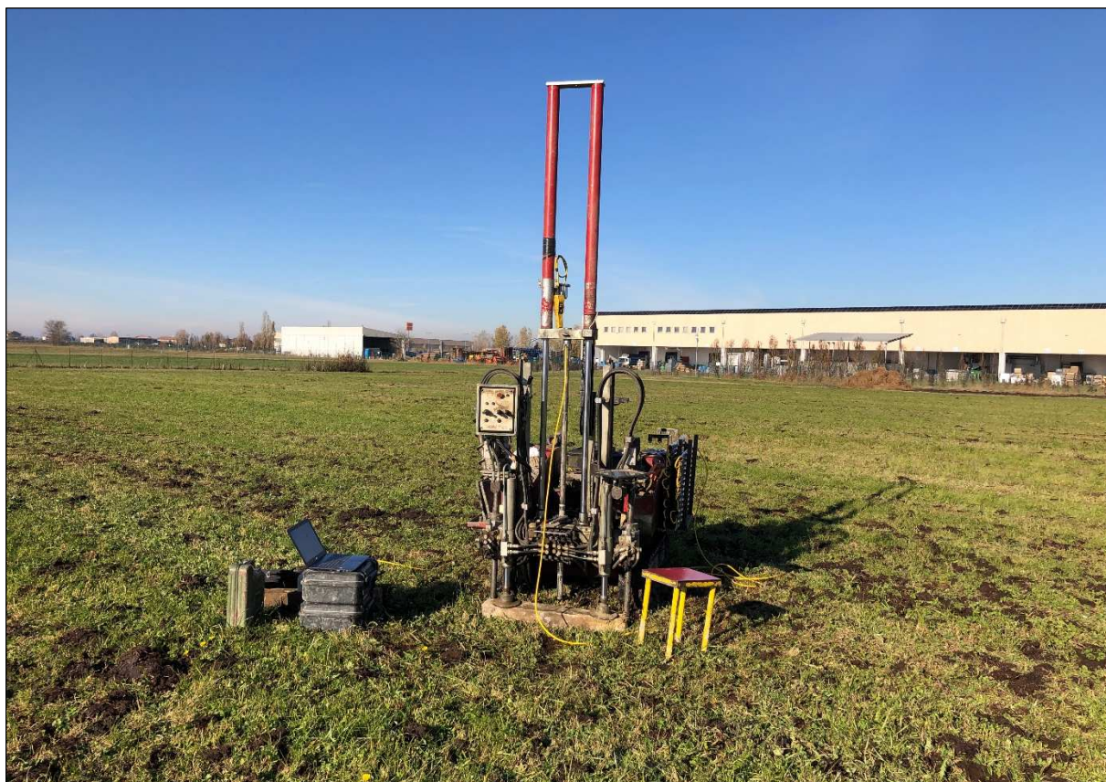
Fig. 4.1-3 Fasi esecutive della prova CPTU3
