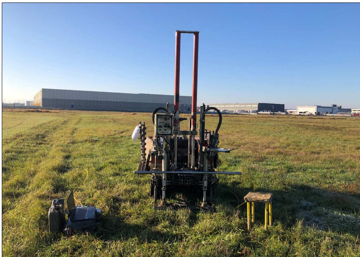
Fig. 4.1-4 Fasi esecutive della prova CPTU4
