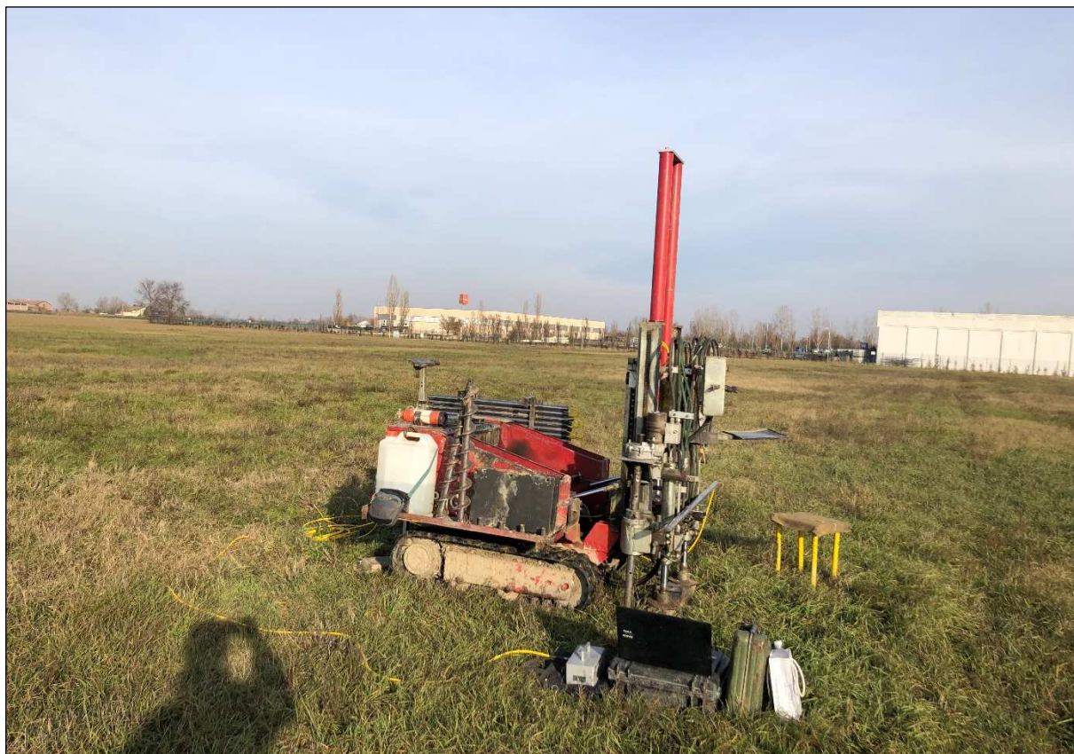
Fig. 4.1-8 Fasi esecutive della prova CPTU8
